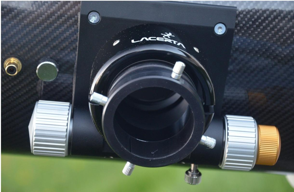
Weit im Inneren sieht man einen Führungsring (=Erhebung), der präzise den Koma Korrektor führt. Links davon sieht man die Chinch Buchse für die Fangspiegelheizung.
