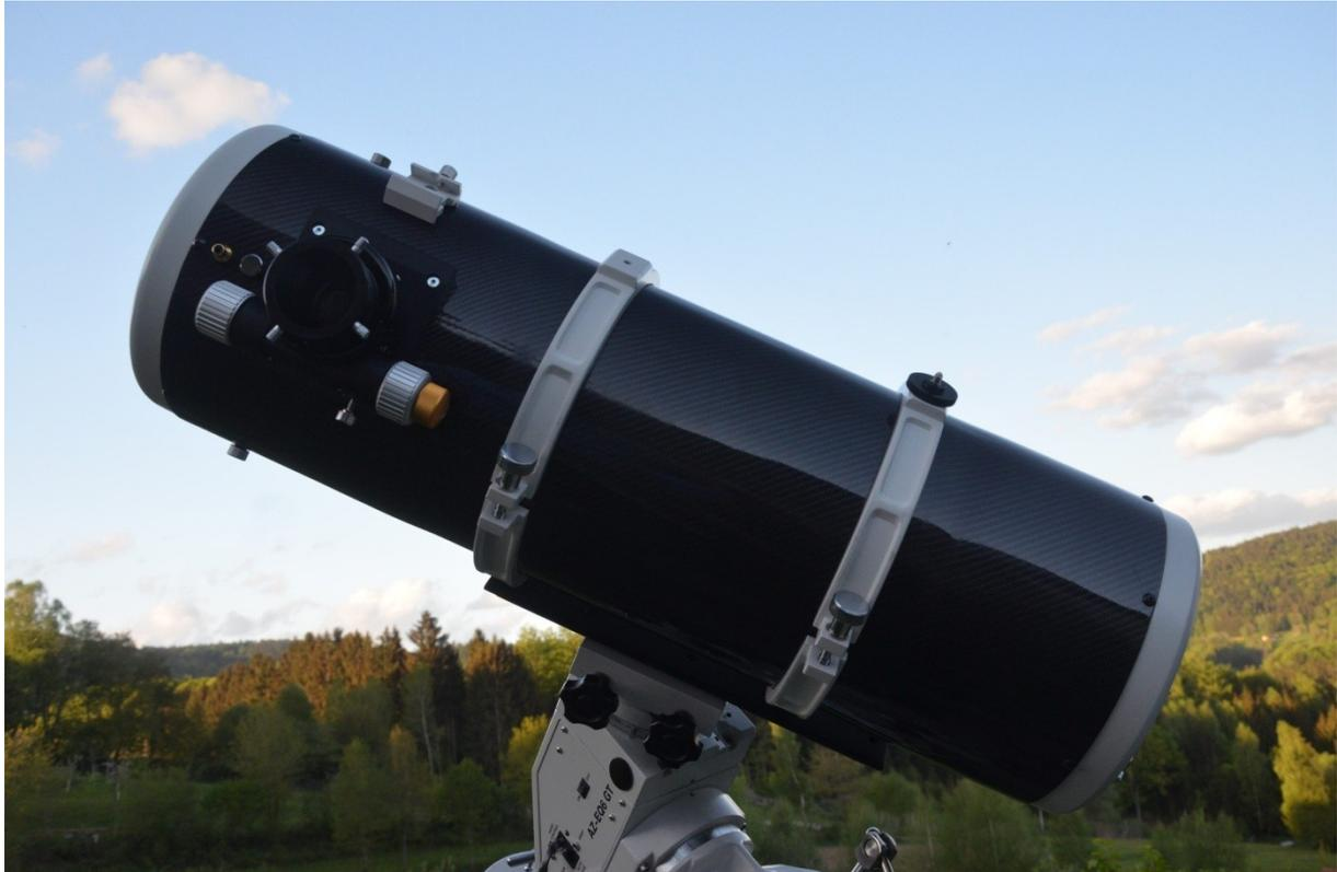
8.4 kg schwer mit Losmandy Prismenschiene und Rohrschellen bei 800 mm Brennweite und 200 mm Öffnung (= schnelle f/4)
