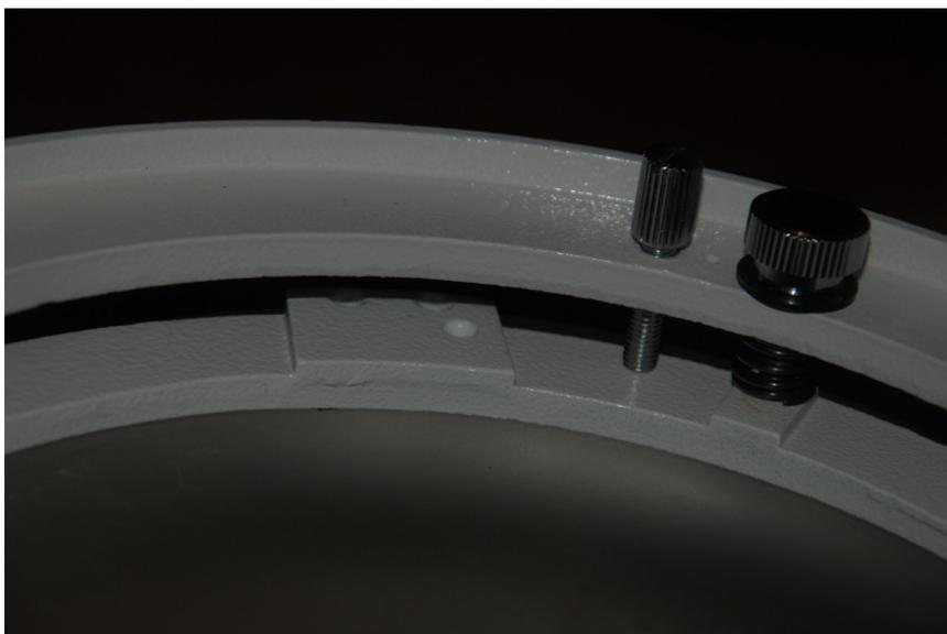
Sehen Sie in der Mitte die erhöht liegende Platte mit den Vertiefungen? Hier sollten wohl die beide Schrauben reingreifen, was durchaus viel Sinn macht. Dann wären diese nicht zu kurz, und die Zelle könnte durch diese Vertiefungen auch nicht rutschen, selbst wenn die Schrauben nicht bombenfest gedreht sind! Und
